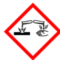
GHS05 – korozivní a žíravé látky
