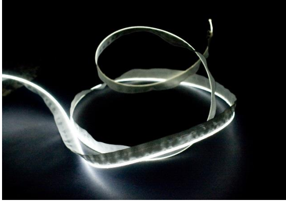
Obr. 21 Pásek se zabudovanými stranově vyzařujícími optickými vlákny [11]
